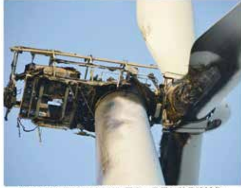
羽根の付け根部分が焼けた風車＝8日午前5時10分、根室市長布盛
