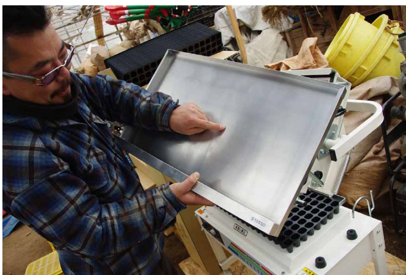
トレイと同じ数の穴が開いた吸盤機
