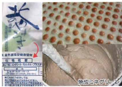
5 メインの壁・天井仕上げは稚内珪藻土。ここにも焼成ミネグリーン。
