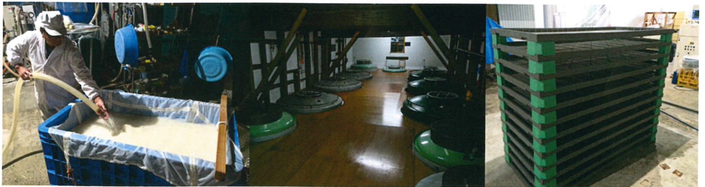
今年度の造りより新たに導入した設備の一部 左上から順に「甎回りクレーン」「アルコール分析器」「酒米定量機」「酒米の浸漬BOX」「サーマルタンク（計9本追加）」「プラスチック製の板（出麹、酒母米などで使用）」
