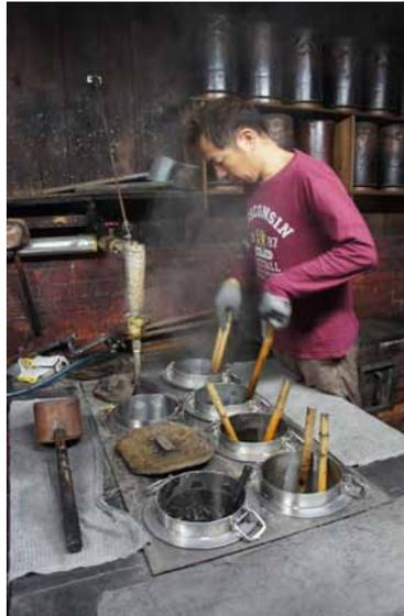
一番作業。早朝5時から始まる。湯煎する膠鍋に水と膠を入れ、上下に叩くように素早く攪拌する。平均になるよう一時間ばかり混ぜる。明日の作業のため、前日に溶かしておく。使用される膠は純度が高い。ちなみに、膠には、ヤギや鹿など珍しいものもある。
