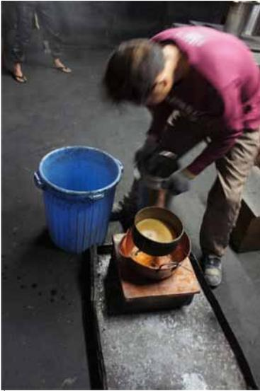
トオシで漉して、不純物を取り除く。漉した物を、職人さんが、微妙な水加減を調整する。その粘性は、長年の勘とデータによる。
