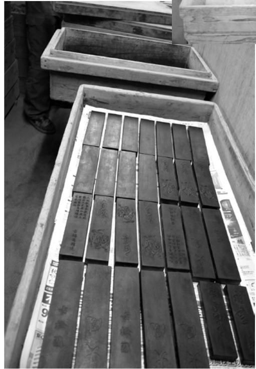
より木灰に含む水分量が少ない箱に、毎日移し換える。10日から1ヶ月間灰乾燥を続ける。最後は水分の含んでいないサラサラに乾燥した木灰の箱に埋めて終了。
